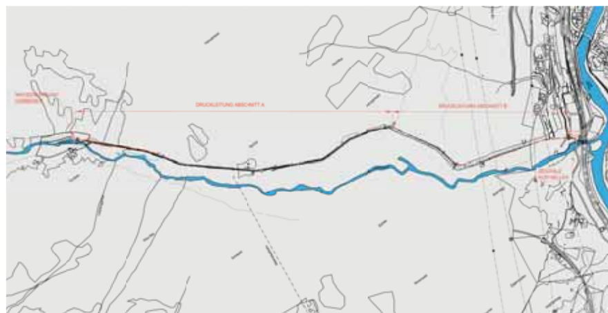
Bild 3 Plan des neuen Trassenverlaufs der Druckleitung.
